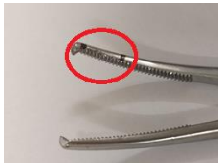
Rys.5 Obraz makroskopowy przedstawiający „zadziór” na krawędzi części pracującej kleszczyków Kochera
