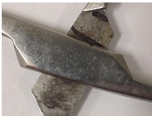
Rys.3 Obraz makroskopowy złącza imadła przedstawiający korozję powierzchniową, osad i liczne pory znajdujące się na powierzchni narzędzia
