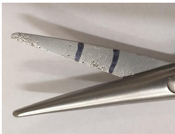
Rys.2 Obraz makroskopowy nożyczek, widoczne liczne pory występujące na jego powierzchni
