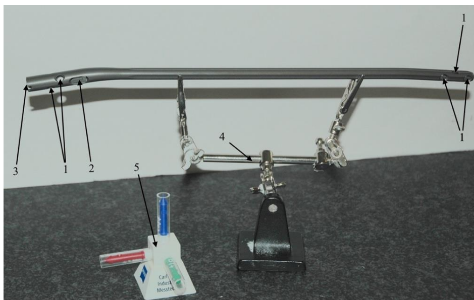
Rys. 1. Badany gwoździec śródszpikowy: 1 – otwory statyczne, 2 – otwór dynamiczny, 3 – otwór pilotażowy, 4 – statyw, 5 – zastosowany układ współrzędnych
