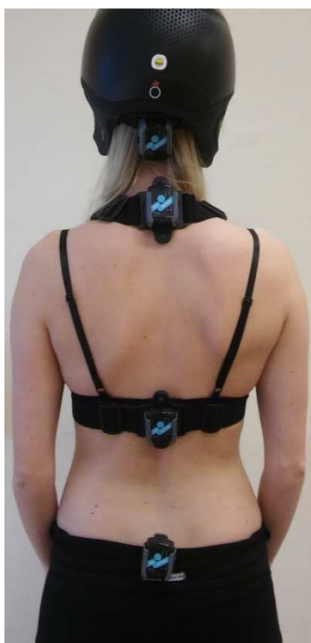
Rys. 8. Schemat rozmieszczenia czujników ruchu [opracowanie własne]
