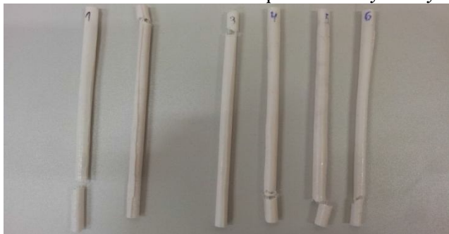
Rys.2. Widok wybranych próbek sztucznych naczyń krwionośnych po próbie rozciągania
