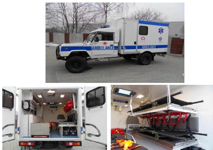
Rys.1. Ambulans sanitarny: a-wygląd zewnętrzny Honkera, b-zabudowa wnętrza, c-zabudowa wnętrza
