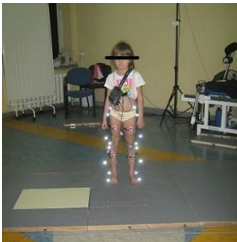
Rys.1. Rozmieszczenie markerów na powierzchni ciała dziecka w trakcie badań stabilograficznych
