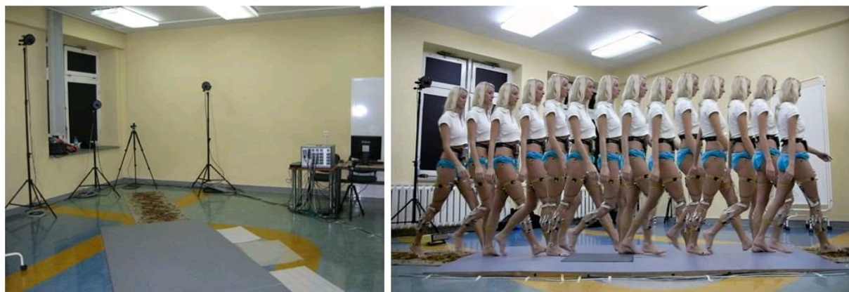
Rys. 2 Optoelektroniczny system do analizy ruchu BTS Smart wraz z zarejestrowanym ruchem przykładowej osoby badanej [4]
