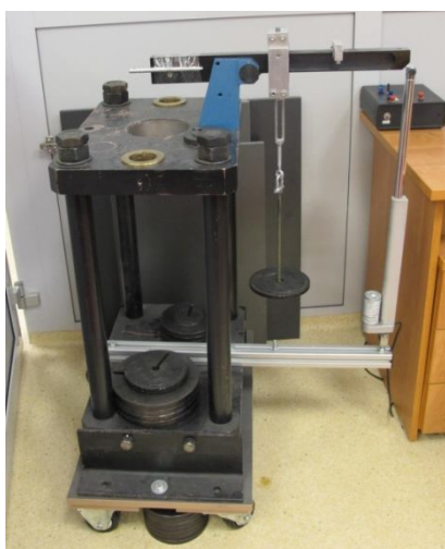
Rys. 1. Kolejno od lewej: stanowisko do badania współczynnika tarcia statycznego oraz jego schematyczna reprezentacja [3]; 1 – wychylne ramię, 2 – obrotowa szalka, 3 – siłownik elektryczny, 4 – wskaźnik laserowy, 5 – odważniki, 6 – uchwyt próbki
