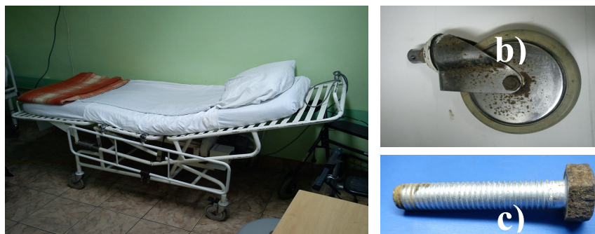
Rys. 1. Obiekt badań: (a) łóżko szpitalne rehabilitacyjne, (b) kółko jezdne łóżka szpitalnego, (c) śruba kółka jezdnego
