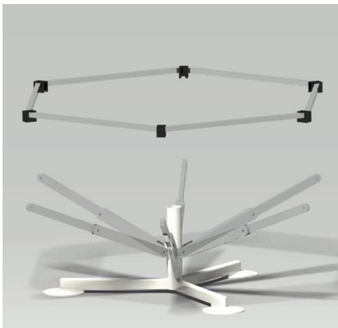
Rys. 2. Układ demontażu stołu (pierścień stabilizujący z łącznikami - u góry, składane wsporniki konstrukcji równoległowodowej - poniżej pierścienia)
