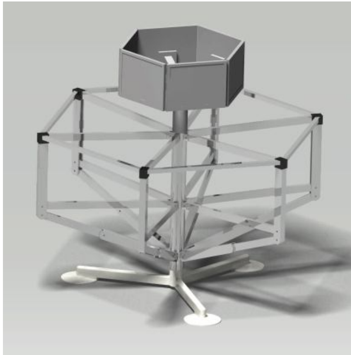
Rys. 5. Rendering gotowego modelu, wykonanego w programie CATIA V5R19
