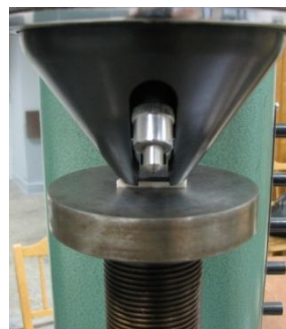
Rys. 4. Próbka cielęca zamocowana w maszynie do badania twardości metodą Vickersa
