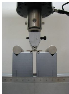
Rys. 3. Próbka wołowa zamocowana w maszynie wytrzymałościowej MTS Insight 50
