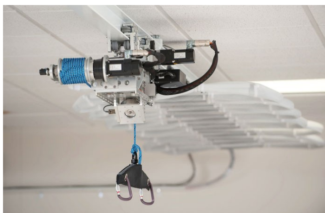
Rys. 3. Widok urządzenia ZeroG zainstalowanego do szyny prowadzącej
