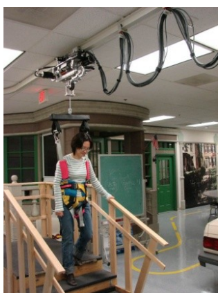
Rys. 2. Ilustracja zastosowania urządzenia ZeroG, tryb pracy w odciążeniu przy schodzeniu ze schodów
