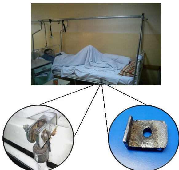
Rys.1. Łóżko rehabilitacyjne. Elementy łóżka rehabilitacyjnego z „ogniskami” korozji
