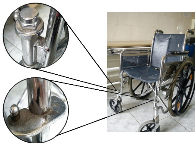
Rys.2. Wózek inwalidzki z elementami miejscowej korozji
