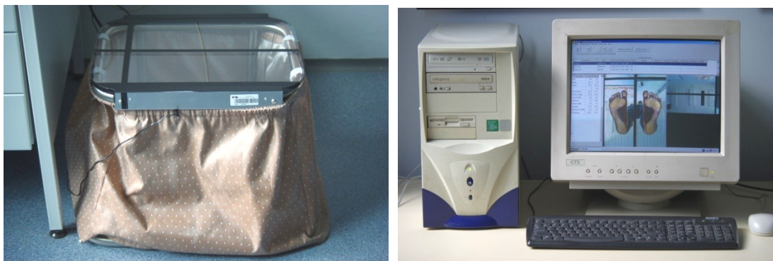
Rys. 3. Podoskop komputerowy wykorzystany do badań
