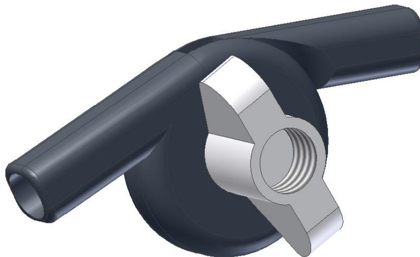
Rys.8. Zawias ze śrubą umożliwiający stabilizację.
