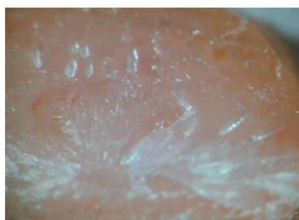
Rys. 9. Przełom mieszany, próbka II., 16x
