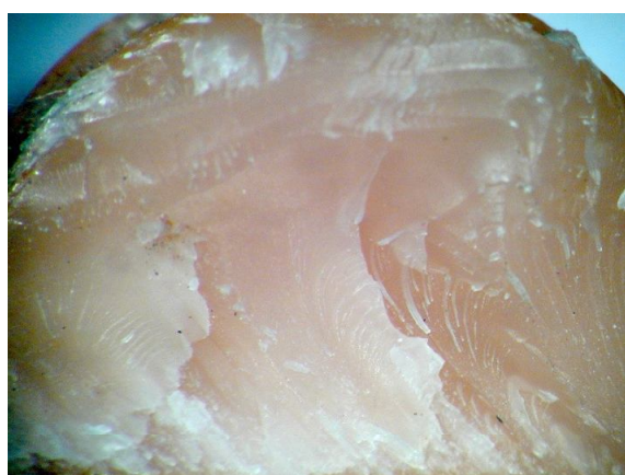
Rys. 8. Przełom kruchy, próbka I., pow. 16x
