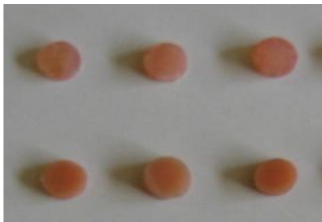
Rys. 10. Próbkki przygotowane do pomiaru twardości.
