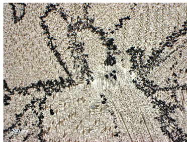
Rys. 6. Struktura części metalicznej, -laboratoryjnego- elementu imitującego łuk protezy, wyraźne granice ziarnowe, trawiono, pow. 50x
