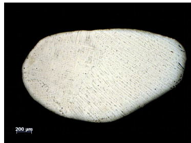
Rys. 4. Struktura łuku protezy, nieliczne defekty przypowierzchniowe, widoczne granice ziarn, trawiono, pow. 50x
