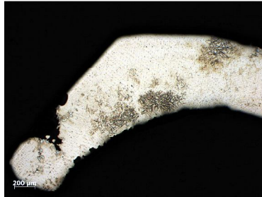
Rys. 3. Struktura części metalicznej siodła protezy, widoczne miejsca dyfuzji, trawiono, pow. 50x
